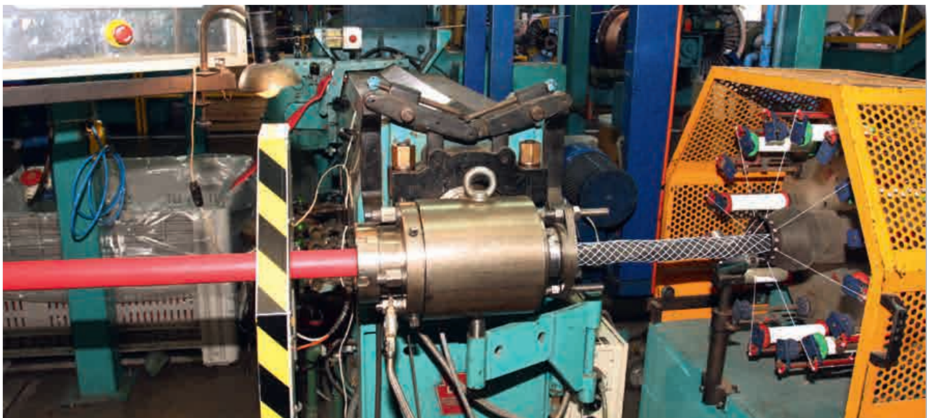
Máquina alimentada con cables de tipo VDF, aplicando refuerzo textil en la fabricación de un cable minero (derecha).
